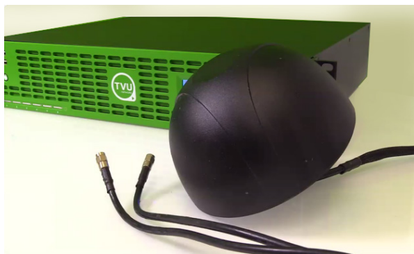
LTE dome antenna
